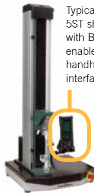
Model 5ST - 5 kN (500 kg/1,000 lbf)
