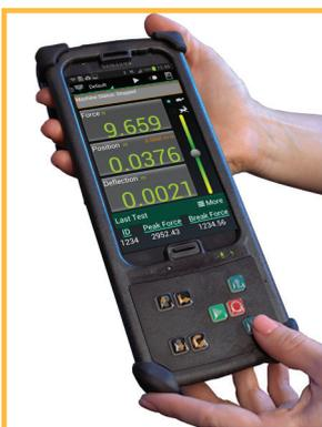
Die drahtlose Handheld-Bedieneinheit wird per Bluetooth mit der Maschine verbunden. Diese Bedieneinheit umfasst eine Androidbasierte Bedienplattform und kann genutzt werden, um die Maschine autonom oder in Verbindung mit der Horizon Software von Tinius Olsen zu steuern.
